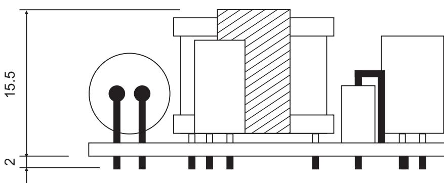
注: 此图为PCB导出尺寸, 误差为( $\pm 1\text{mm}$ )详细尺寸请根据实物为准
